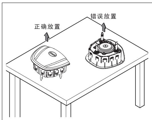
(d). 取下驾驶员安全气囊总成，并安全放置。
